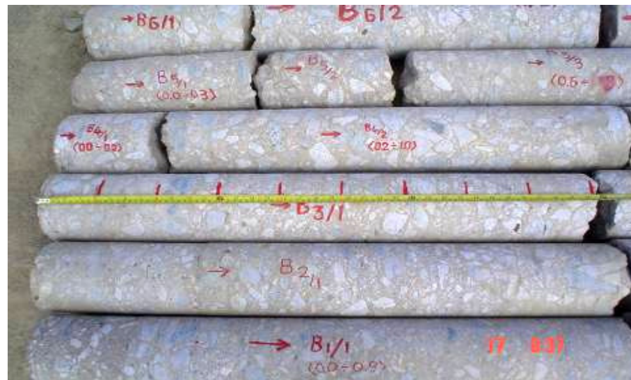
Ảnh. Mẫu nôn khoan RCC tại bãi thí nghiệm bê tông đầm lặn công trình thủy điện Sê San 4.
